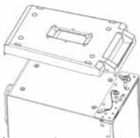
図1. スピーカーモジュールエンドキャップを取り外す
